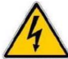
Tensione elettrica pericolosa
